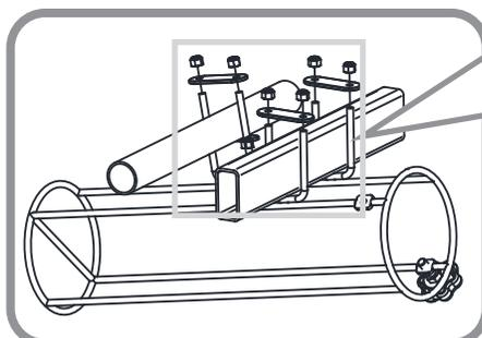
④①で取り外したステーを挿入し、ナットを仮締めします。
