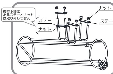
①ボンベ架にステーとナットが仮組みされていますので、分解します。
