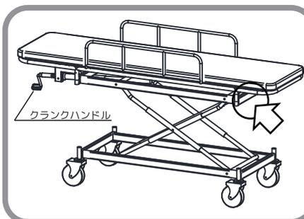
②ボンベ架は、クランクハンドルとは反対側の、上部フレームに向かって左側に固定します。
