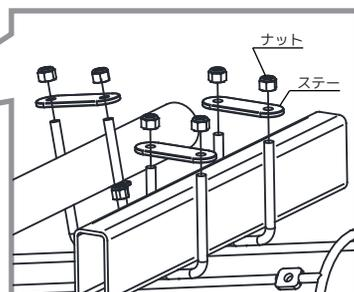
⑤対辺 10mm スパナで、ナットを締結します。この際、ボンベ架が少し動く程度に締結してください。
