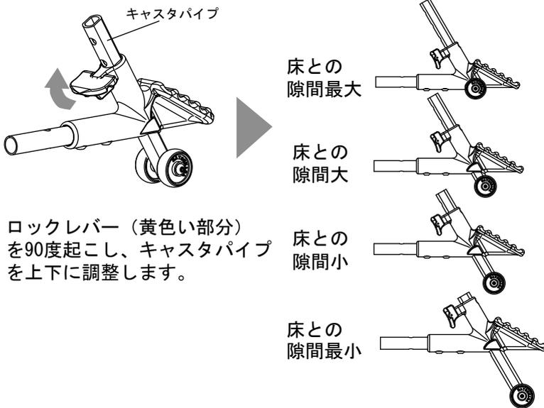
ロックレバー（黄色い部分）を90度起こし、キャストパイプを上下に調整します。
