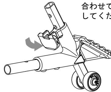
高さは4段階調整できるので、前座高と使用状況に合わせて高さ調整してください。
