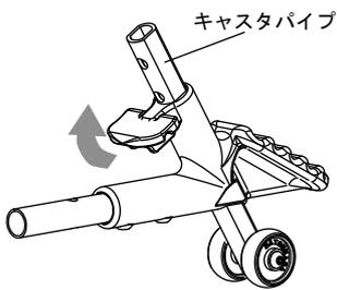
ロックレバー（黄色い部分）を90度起こし、キャストパイプを上下に調整します。
