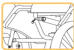
2 ナットを取り外し、ボルトを外してください。
