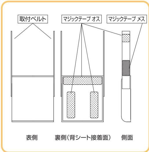
② バックサポートフレームパイプに左右取付ベルトを巻き付け、マジックテープで固定してください。ポケット裏側のマジックテープを、車椅子本体背シートに貼り付け固定してください。
