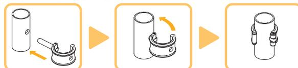
穴にピンを差し込みます。矢印方向に回転させます。反対側の穴にピンの頭が出ていることを確認します。
