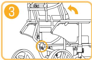
4 2で外したボルト、ナットを図のように取り付けます。ナットは手で軽く締めてください。
