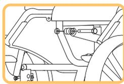
3 背もたれを起し、連結部をガスダンパーに合わせます。
